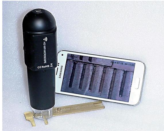
Questo tipo di microscopi, dalla vaga forma di supposta e dal prezzo variante fra i 10 ed i 50 Euro, hanno innumerevoli varianti: l'ingrandimento con ottica zoom che va da 20x a 200x e talvolta anche più, la risoluzione che va dalla minima VGA a dei fantasiosi 5 Mpx, ottenuti con estreme quanto inutili interpolazioni. Spesso sono dotati di supporto a colonna, con tanto di mini cremagliera e di programma di analisi delle immagini, con misurazione in automatico e vetrino di calibrazione.
