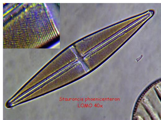
Il test ha confermato ancora una volta la ottima qualità delle ottiche, con la perfetta risoluzione delle "strie" ed, in parte, anche dei "dot" (vedi particolare).
